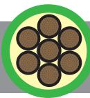
Cavi comando e segnalamento, isolati con gomma G16, sotto guaina termoplastica, con conduttori flessibili per posa fissa. Non propaganti l'incendio e a basso sviluppo di fumi e gas tossici e corrosivi (atossici - privi di alogeni - LS0H).
