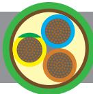
Cavi multipolari per energia schermati a nastro, isolati con gomma G16, sotto guaina termoplastica, con conduttori flessibili per posa fissa. Non propaganti l'incendio e a basso sviluppo di fumi e gas tossici e corrosivi.
