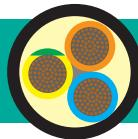
Cavi multipolari flessibili per energia, isolati in gomma, senza alogenzi e a bassa emissione di fumi.
