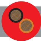
Cavi per sistemi di rilevazione e di segnalazione allarme d'incendio, resistenti al fuoco, non propaganti l'incendio, multipolari schermati, isolati con mescola reticolata S29, sotto guaina termoplastica di tipo M16, con conduttori flessibili per posa fissa. Non propaganti la fiamma e a basso sviluppo di fumi e gas tossici e corrosivi.
