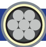
Cavi unipolari per energia, isolati con gomma di qualità G16, sotto guaina di PVC di qualità R16, con conduttori rigidi di alluminio per posa fissa. Non propaganti l'incendio, a ridotta emissione di alogenzi (gas corrosivi).
