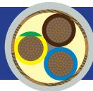
Cavi multipolari per energia, schermati a calza, isolati con gomma G16, sotto guaina di PVC, con conduttori flessibili per posa fissa. Non propaganti l'incendio, a ridotta emissione di alogen (gas corrosivi).
