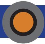
Cavi unipolari per energia, isolati con gomma G16, sotto guaina termoplastica M16, con conduttori rigidi per posa fissa. Non propaganti l'incendio e a basso sviluppo di fumi e gas tossici e corrosivi (atossici - privi di alogen - LS0H).
